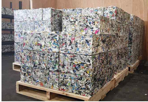
<그림 2.1> 증기와 압축의 물리적 가공 과정만으로 재활용한 바이블록 제품 (출처 : BIZION, 2022)
