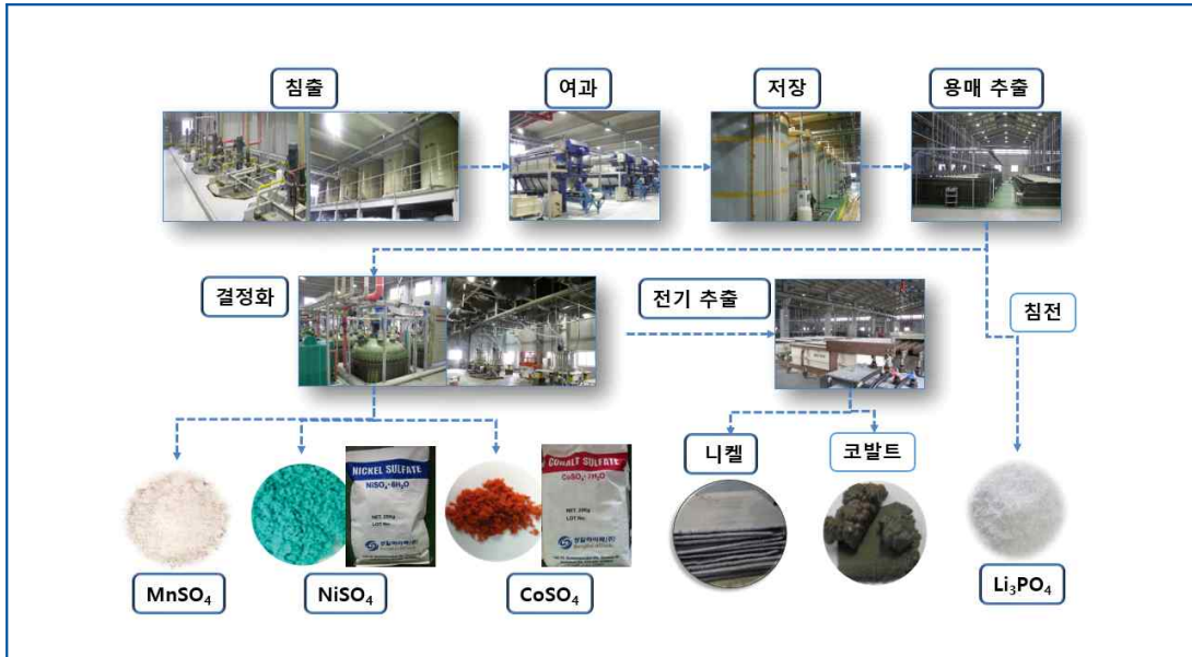
〈그림 2.14〉 국내 전기차 폐배터리의 재활용 공정 (출처 : 손정수, 2018)
