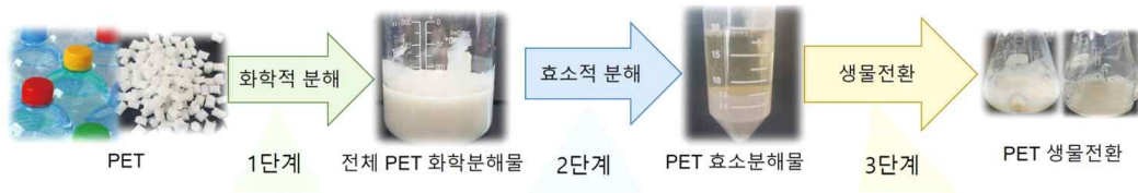
<그림 2.9> PET 사슬 끊는 촉매/미생물 이용한 통합 공정
