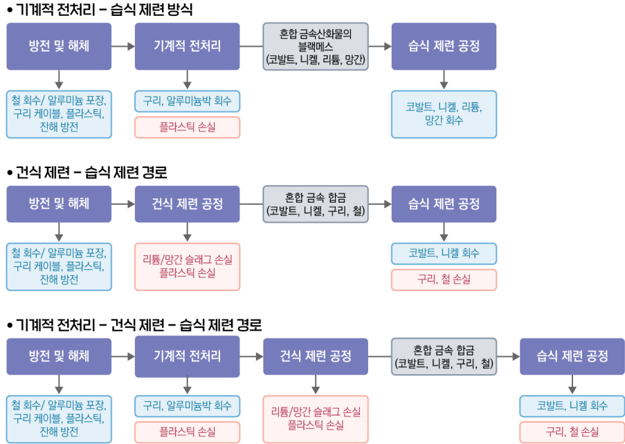
그림 3 사용후 배터리 재활용 공정 모식도
